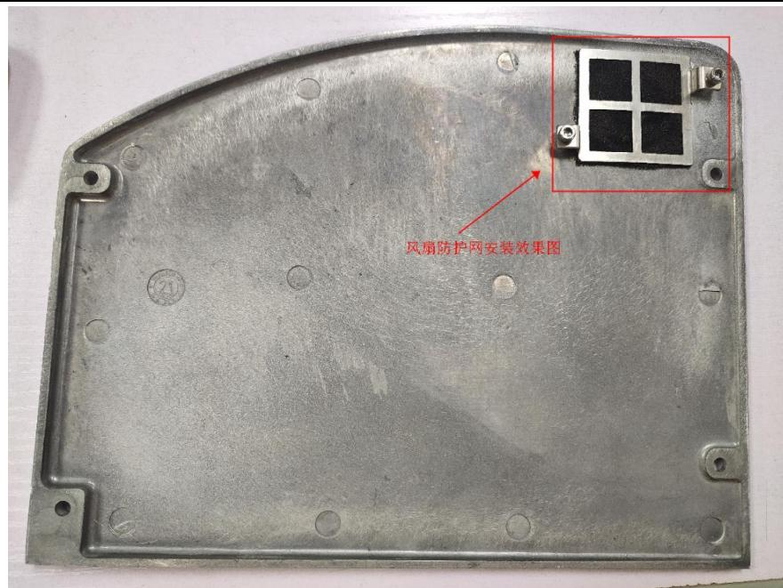
图 5-14 风扇防护网安装图
